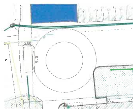
Dalle béton adaptée à la tour MA20 ainsi que le rayon de braquage nécessaire
